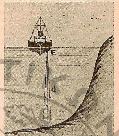
Η εικόνα δείχνει πώς γίνεται ή μέτρησης του θαλασσίου βάθους με ήχοβολιστικό μηχανήμα. Τα βέλη δείχνουν την πορεία των ήχητικών κυμάτων.
