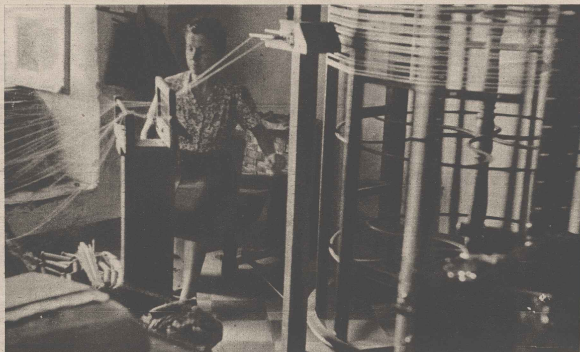
ΤΑ ΚΑΡΟΥΓΙΑ είναι βαλμένα πάνω στή καρουλιέρα κ' οί μεταξωτές κλωστές περνούν άπ' αυτή στό στημόνι. Τò στημόνισμα γίνεται χωριστά για τò μαλί και χωριστά για τò πανί τού βελούδου. Είναι 80 κλωστές για τò πανί και 40 για τò μαλί. Κι αυτό επίσης είναι μιá προπαρασκευαστική δουλειά, για τή καθαυτό υφανση και πληρώνεται χωριστά άπ' τόν έργοδότη. Τετρακόσιοι άργαλειοί χειροκίνητοι κι άπ' αυτούς έκαστò περίπου μόνο για τò βελούδο κι οί άλλοι για τή ποικιλία τών μεταξωτών, είναι κάθε μέρα σέ κίνηση στό Τζοάλι. Σχεδόν κάθε σπίτι έχει κ' έναν, δέν είναι όμως σπάνιο νά βρεθούν κάτω άπ' τήν ίδια στέγη δύο και τρείς, σέ μεγάλη κίνηση. Είναι ή αιώνια δόξα τού Τζοάλι.
