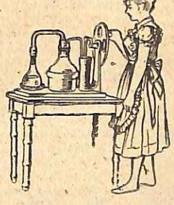
Ψυκτική συσκευή δι' αεραντλίας και θειικού όξέος.
