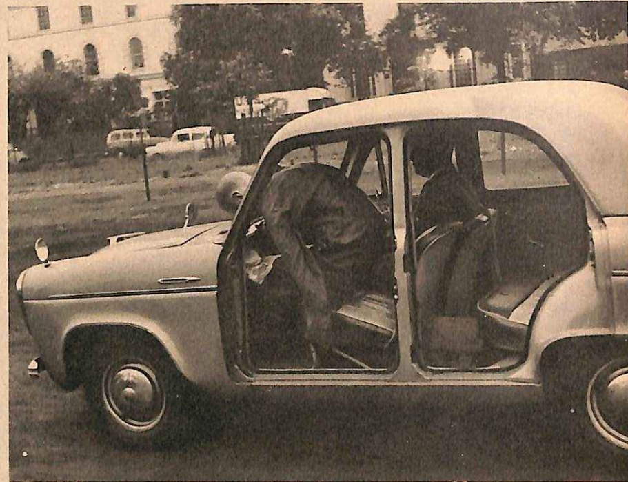
Ο ΑΤΥΧΟΣ «ΜΠΑΤΣ», το ανδρείκελο, τραυματίστηκε σοβαρά με το ξαφνικό σταμάτημα. 'Ο οδηγός, όμως, δεμένος στο κάθισμα, είναι σώος.
