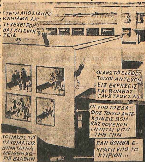
Ἀνω: Καταφύγιον διὰ 1200 ἄτομα, ἱκανὸν νὰ ἀντέξῃ εἰς θόμβας θάρους 500 λιτρῶν. Δεξιὰ: Μία ἐταιρεία ἀρωμάτων κατεσκεύασε διὰ τὸ προσωπικὸν τῆς ἄστυος μὲ δύο ἐξόδους.
