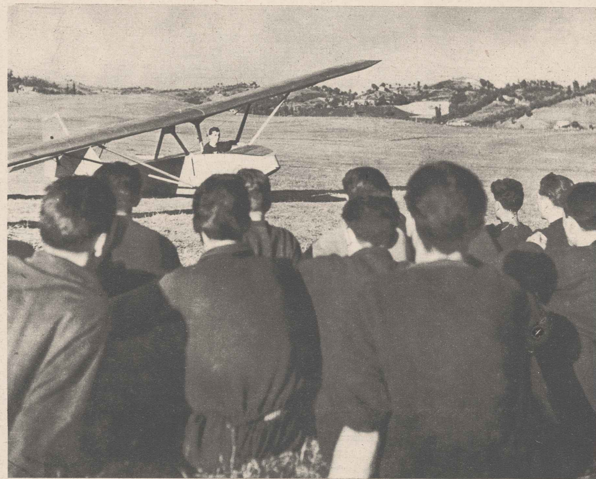
ΠΡΩΤΑ ΠΕΙΡΑΜΑΤΑ: ἀεροπλάνον ἀνευ κινητήρος, δεμένον εἰς χονδρὸν σχοινίον, τὸ ὁποῖον θὰ τὸ σύρῃ καὶ θὰ τοῦ ἐξασφαλίσῃ τὴν πρῶτην κίνησιν. Ἐλευθερούμενον θὰ ὑψωθῇ ἐλαφρὸν εἰς τὸ κενόν.
