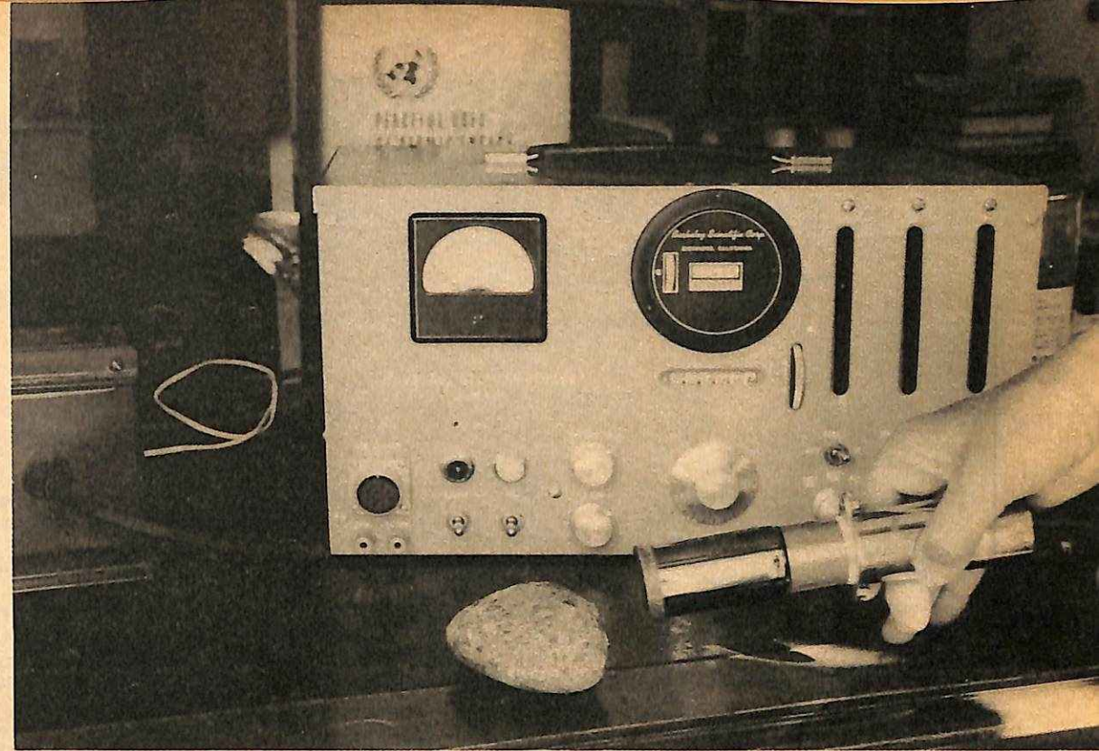
Η ΡΑΔΙΕΝΕΡΓΕΙΑ ἐπιδρά στὴ λυχνία τῆς εἰδικῆς συσκευῆς ἀνιχνεύσεως καὶ ἀμέσως μετατρέπεται σὲ ρυθμικοὺς ἤχους, ἐλαφροὺς σπινθηρισμούς, ἢ ἀριθμητικὲς ἐνδείξεις στὸ «καντράν» τοῦ μετρητῆ.
